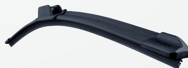
幅広い車種、多様なアーム圧やウインドウガラスの曲率に対応させるため、R形状が異なる複数の金属レールを設計。膨大な実車計測記録から最適な組み合わせでラインナップを揃えています。
